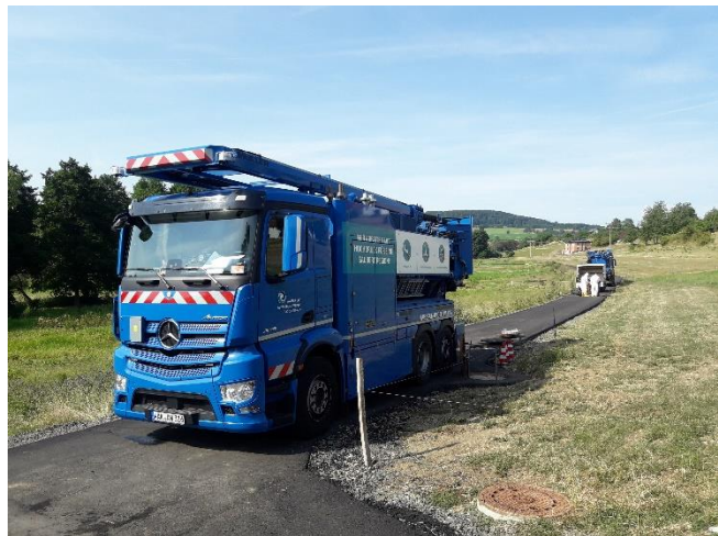
WVS Saug- und Spülfahrzeug zur Kanalreinigung
